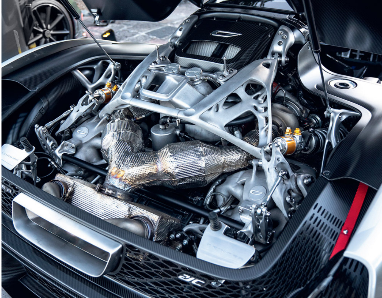
Pogled na motorni prostor Czinger modela 21C, s komponentama izrađenima uz primjenu metalne aditivne proizvodnje – od šasije do kočnica, ovjesa i ispušnog sustava
