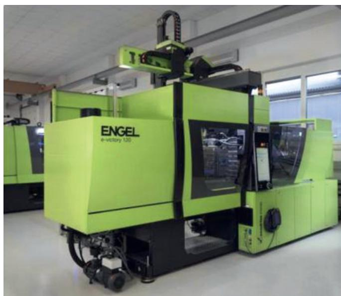
Zahvaljujući pristupačnoj jedinici za zatvaranje, mašina za brizganje e-Victory bez vođica, omogućava visoku efikasnost u procesu prerade silikona (LSR).
