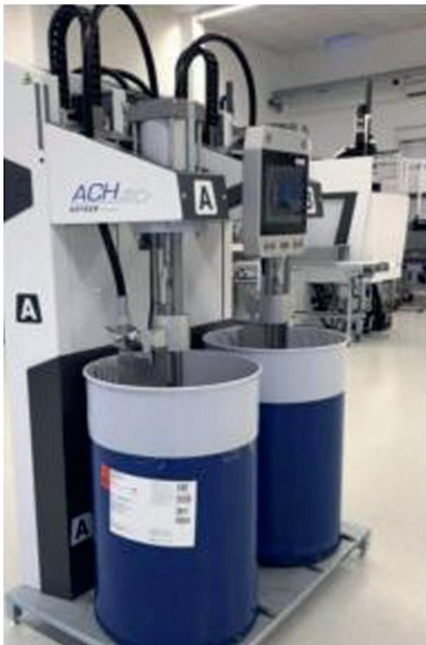
Sistem MaxiMix G2 proizvođača ACH-Solution se koristi za pripremu silikona. Ceo proces može biti kontrolisan pomoću CC300 upravljačke jedinice na Engel e-Victory mašini.
