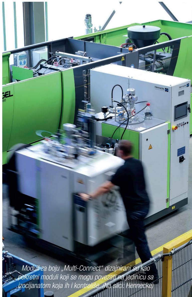
*Moduli za boju „Multi-Connect“ dizajnirani su kao pokretni moduli koji se mogu povezati na jedinicu sa izocijanatom koja ih i kontroliše. (Na slici: Hennecke)*
