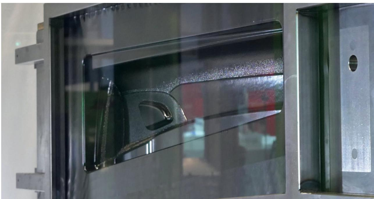
*Slika 5. Proces termoformiranja počinje tokom zagrevanja folije u IMG alatu*
