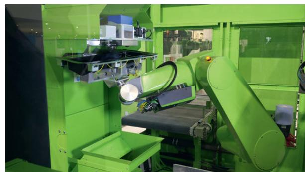
*Slika 6. Za DecoJect proizvodna celija integriše 6-osni robot i stanicu za lasersko obrezivanje proizvoda koji se na kraju odlaze na traku*
