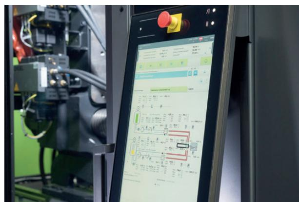
CC300 kontroler kod mašina za brizganje kontroliše celokupan proces, uključujući i obradu PU. (Na slici: ENGEL)
